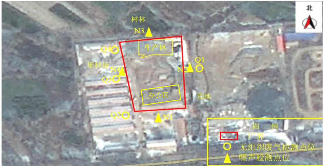
图5.2-1 项目厂区平面布置及检测点位示意图
