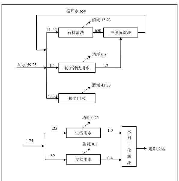
图 1-1 项目水平衡图 (m³/d)
